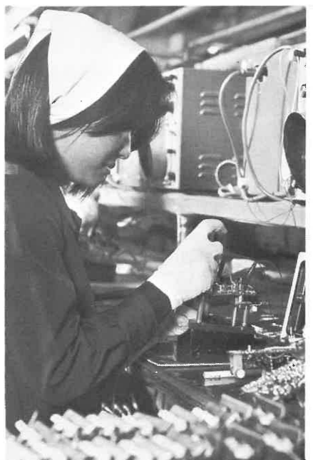
零件鑲嵌是製造電子產品的開端。
